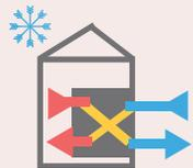
L'air froid et frais de l'extérieur est réchauffé dans l'échangeur de chaleur par l'air chaud de l'intérieur et arrive ainsi frais et réchauffé dans la maison
