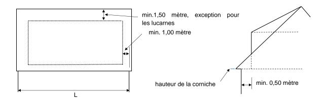
La toiture à double pente brisée, comble à la Mansart, a pour la partie supérieure une pente comprise entre 25 et 30 degrés et pour la partie inférieure la pente maximale est de 70 degrés. Cette partie inférieure a une hauteur maximale de 1,50 mètre, mesurée à partir de la corniche.
