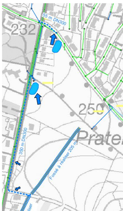
Abbildung 5 Auszug aus der étude du réseau d'assainissement
